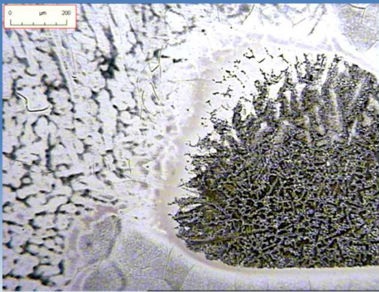
X 100 – Titane \beta 21S. Soudage Tig à proximité d'une brasure
