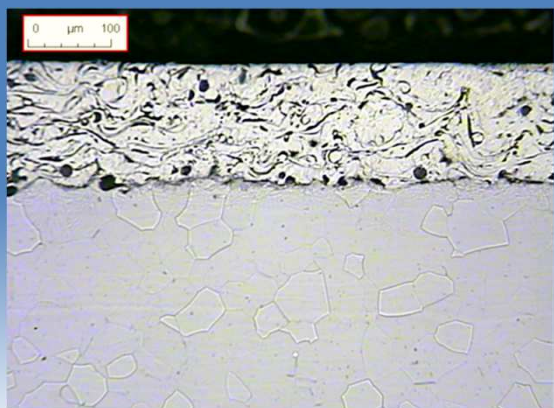
X 200 - Titane \beta 21S + dépôt plasma
